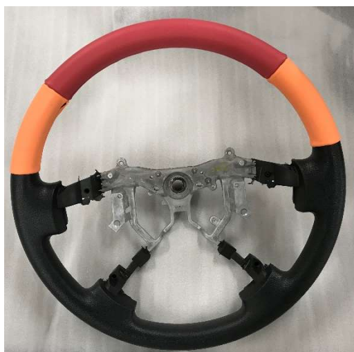
図7 カラーフッ素ゴム製ハンドルカバー試作品（オレンジと赤色部がフッ素ゴム）
