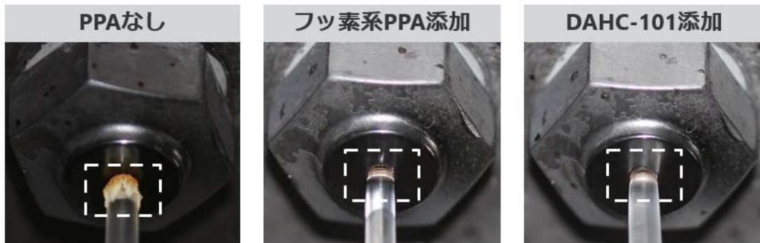
図3. ダイビルドアップ（目ヤニ）発生の様子
