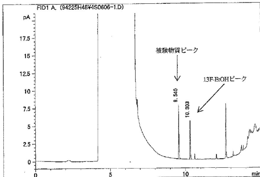
付図3-2-1 標準溶液のGCクロマトグラム（暴露開始時）
